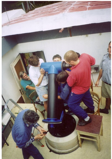
Obr. 3 — Usazení deklinační osy je nejkritičtější okamžikem sestavování dalekohledu.
