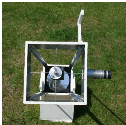
Obr. 7 — (a) Olovené závaží připevněné na spodní části tubusu. (b) — Pohled zředu do tubusu; na horním dílu jsou přišroubována jednoduchá mířidla.
