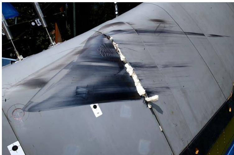
Obr. 2 — Po první „střelbě“ zůstaly části pěnové izolace zaklíněné mezi maketami panelů RCC. Foto NASA.
