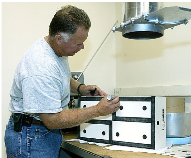
Obr. 3 — Takto vypadá „projektil“ – vzorek izolační pěny má hmotnost i rozměry přibližně takové, jako kus který se odtrhl z izolace hlavní nádrže ET při startu Columbie. Foto NASA.
