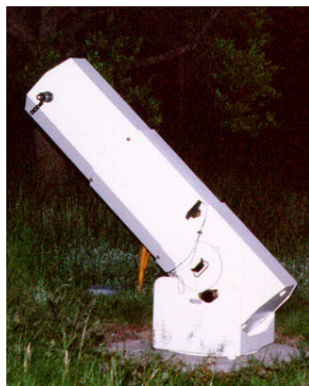
Obr. 4 — Pozorovací stanoviště, odkud byla vizuální přehlídka galaxií provedena, a použitý přístroj: newtonův dalekohled o průměru 42 cm a ohniskové vzdálenosti 200 cm, s dobsonovou montáží.
