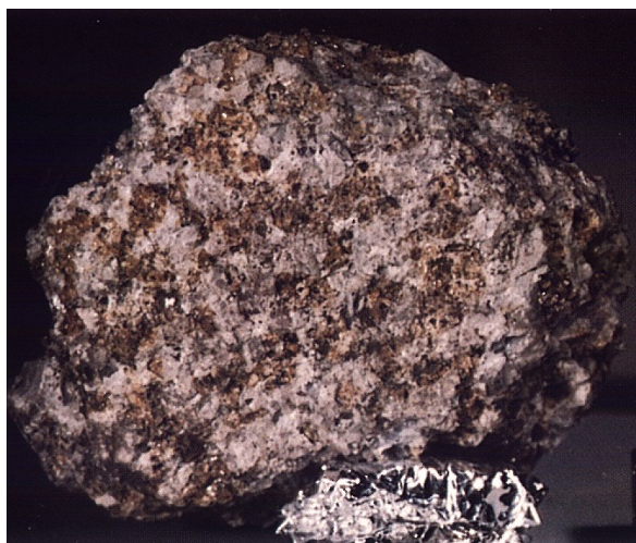
Obr. 6 — Troktolit, méně častá hornina měsíčních pevnin. Vzorek získaný Apollem 17 z úpatí Severního masívu pohoří Taurus–Littrow, původně vzniklý patrně v hloubce 10 až 30 km, obsahuje 58 % plagioklasů, 37 % olivínu a 4 % kosočtverečných pyroxenů. Stáří přes 4,26 miliard let, velikost asi 6,5 cm krát 5,5 cm, hmotnost 156 g. Převzato z [4].
