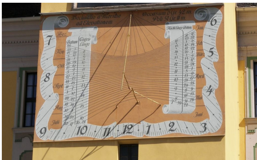
Obr. 2 — Sluneční hodiny v Bautzen (DE SC 4) před radnicí. Mají jemnou stupnici časovou (po 5 minutách) i kalendářní (asi 35 kalendářních čar).
