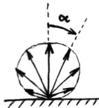
Obr. 13 — Lambertův zákon rozptylu, znázorněn jako rozptylový diagram ve tvaru koule přiléhající k povrchu.
