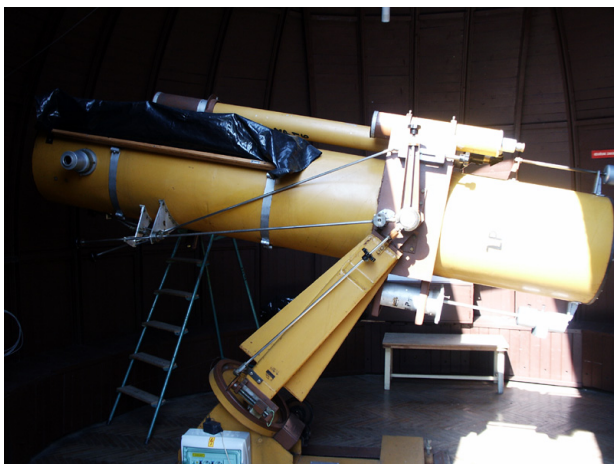
Obr. 5 — Newton 440/2850 pod kopulí.
