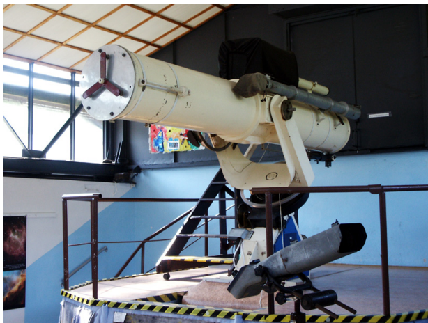
Obr. 4 — Dalekohled Newton 330/3110 pod odsuvnou střechou.
