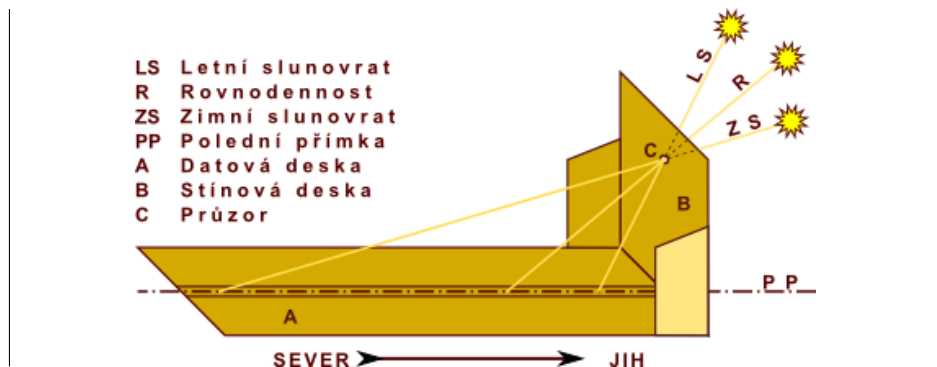
Obr. 7 — Princip štěrbinových poledních slunečních hodin.
