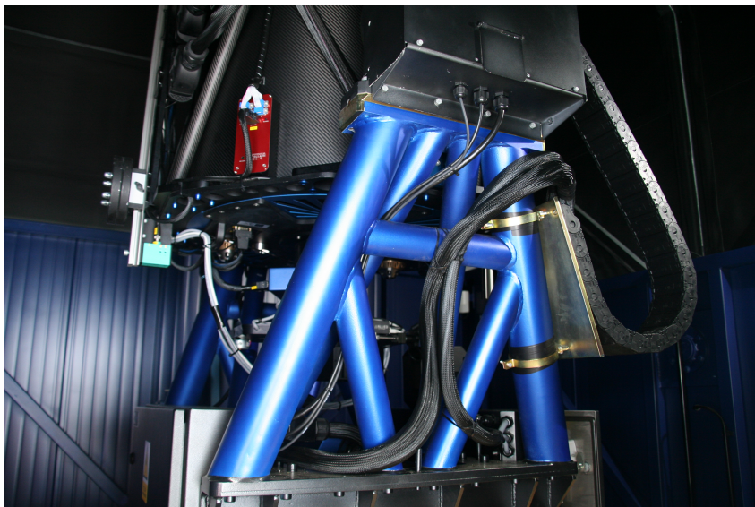
Obr. 6 — Alt-azimutální montáž dalekohledu. Vidlice je vyrobena z oceli, přičemž výztuže zajišťují minimální průhyby konstrukce.
