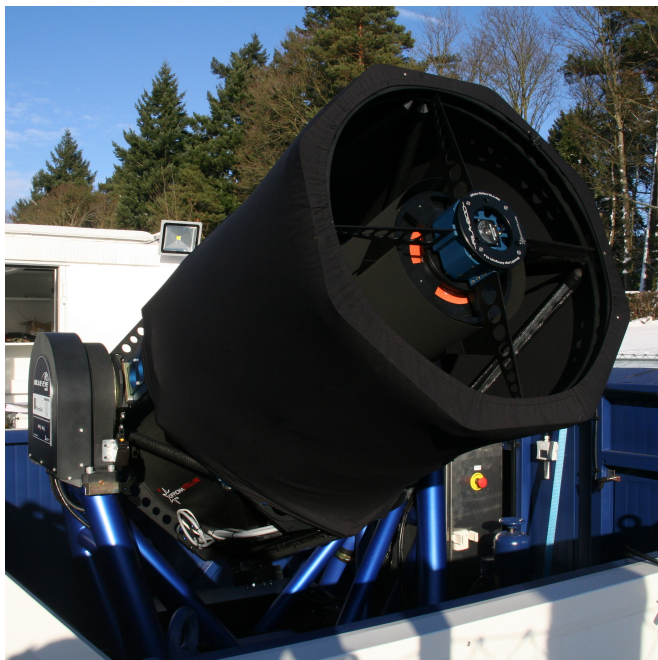
Obr. 3 — Dalekohled Officina Stellare Rila 600, s průměrem primárního zrcadla d = 600 mm, ohniskovou vzdáleností f = 3000 mm a optickým systémem Ritchey–Chrétien s tříčočkovým korektorem. Díky korekci obrazu kreslí v celém zorném poli na difrakčním limitu (viz obr 4); v praxi tedy bude rozhodovat seeing. V konstrukci dalekohledu je použito karbonu a hliníku.
