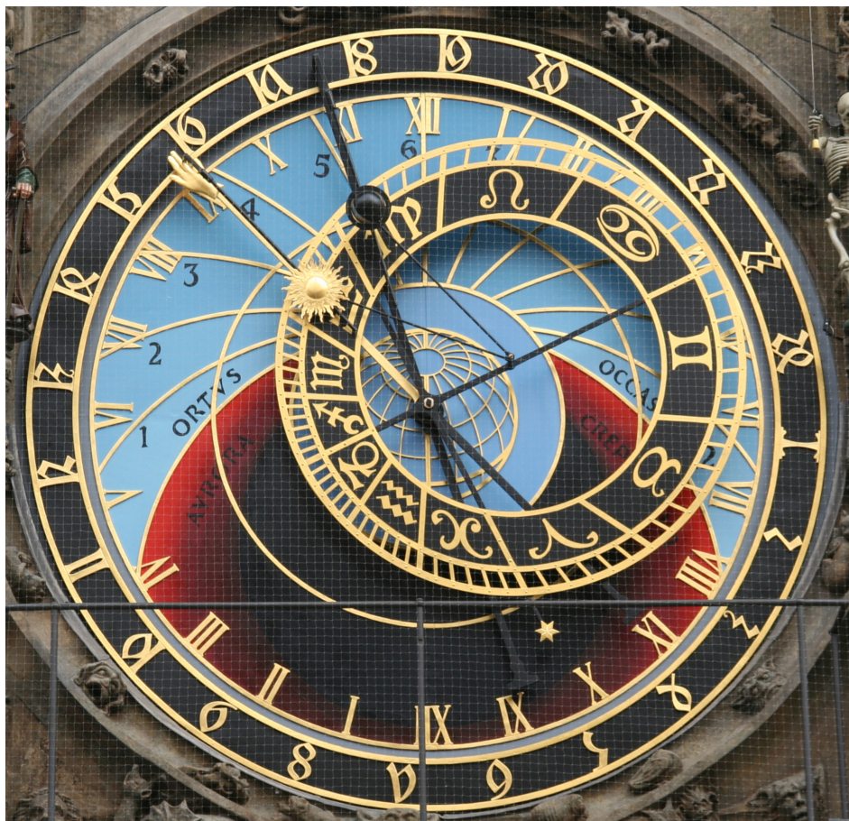
Obr. 6 — Astroláb Pražského orloje v říjnu 2018. Na astrolábu lze číst následující prvky (od vnějšího kraje): gotické číslice (1–24) ukazující staročeský čas od západu Slunce předchozího dne, umístěné v pohyblivém mezikruží poháněném vačkovým mechanismem, obratník Raka, římské poloroljní číslice (I–XII) pro středoevropský čas, arabské číslice (1–12) temporálních hodin, dělíci světly den vždy na 12 stejných úseků, rovník, obratník Kozoroha, horizont, latinské nápisy „ORTVS“ (východ), „OCCASVM“ (západ), „AVRORA“ (svítání), „CREPVSCVLVM“ (soumrak), občanský soumrak (neostřý), astronomický soumrak (dtto), ekliptiku, přičemž správná je vnější kružnice, a 12 znamení zvěrokruhu. Ručička ukazuje SEČ, hvězdička hvězdný čas (na stupnici pro SEČ), Slunce pochopitelně polohu Slunce na obloze i na ekliptice, Měsíc polohu Měsíce i jeho fáze, které se mění díky mechanismu skrytému uvnitř Měsíce.
