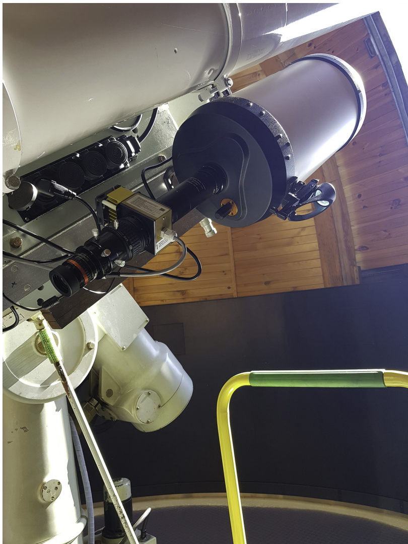
Obr. 1 — Dalekohled Triband-SCT s filtrem Solar Spectrum v kopuli hradecké hvězdárny.
